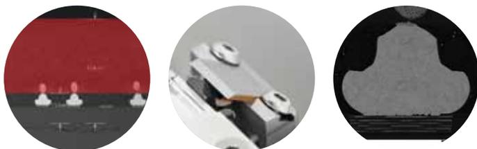
**特别的棱形挡板:** 在金线接点的上方约300 $\mu\text{m}$ 的“无用”部分被徠卡EM TXP去除。然后与特别设计的棱形挡板相配合, 在1小时之内(包括样品前处理)即完成全部样品处理过程。
