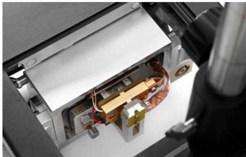
**多种多样的样品载台:** 几乎适合于各式尺寸样品, 并适合于广泛用途。如用一个样品托, 就可以完成前机械制备 (徕卡EM TXP) 至离子束切割 (徕卡EM TIC 3X), 以及SEM镜检, 然后再放入样品存储盒中以备后续检测。
