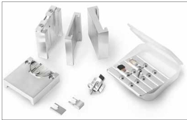
标准样品台配套的衬度增强样品载台：1)样品处于离子束切割的位置；2)在低kV下进行几分钟的衬度增强作用
