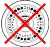
시료는 동일량으로 정확하게 측정하여 각각의 튜브에 담고, 튜브는 서로 대칭이 되도록 배열하여 로터에 삽입하여야 합니다. 이때 대칭되는 시료의 용량이 다르다면 로터가 회전할 때 심한 진동이 발생하며 로터, 회전축에 손상이 가하게 됩니다.
